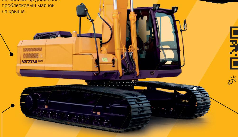
**СДВОЕННЫЙ ГИДРОНАСОС ПЕРЕМЕННОЙ ПРОИЗВОДИТЕЛЬНОСТИ** в паре с мощным двигателем обеспечивают превосходную производительность и экономичность экскаваторов ЧЕТРА. Дополнительная гидролиния расширяет функциональные возможности экскаваторов ЧЕТРА и позволяет использовать вспомогательное гидрофицированное навесное оборудование. Опционально экскаваторы комплектуются гидромолотом.
