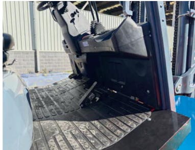
Цилиндры наклона расположены под полом, что увеличивает пространство для ног оператора
