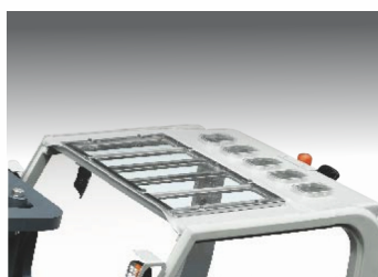
Цельная и штампованная конструкции крыши ограждения водителя повышает прочность и обеспечивает безопасность
