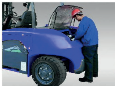
Удобное расположение блока с контроллерами электрокомпонентами для обслуживания
