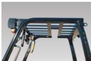
Усиленное защитное ограждение
