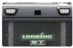
Оборудован светодиодными задними фонарями и камерой.
